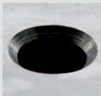
Svasatura con svasatore cilindrico standard
