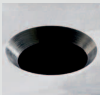
Svasatura con svasatori cilindrici a taglienti elicoidali
