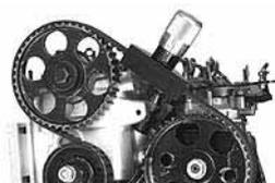
Misurazione della tensione della cinghia dentata.
