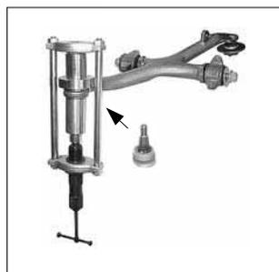
**Nota:** Se necessario, il mandrino idraulico KL-0045-70 può essere sostituito mediante il cilindro idraulico KL-0040-2500.
